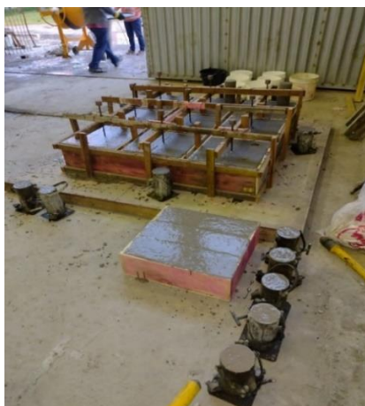
Figura 3.12 - Moldagem dos corpos de prova
