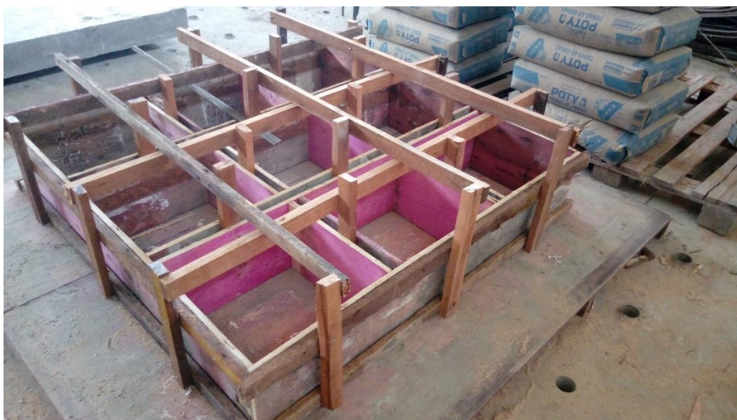
Figura 3.7 - Forma dos corpos de prova para o ensaio de arrancamento
