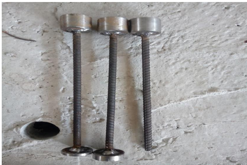
Figura 3.8 - Conectores de aço CA-50 com cabeças soldadas, submetidos ao ensaio de arrancamento
