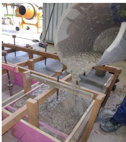
Figura 3.11 - Lançamento do concreto geopolimerico nas formas
