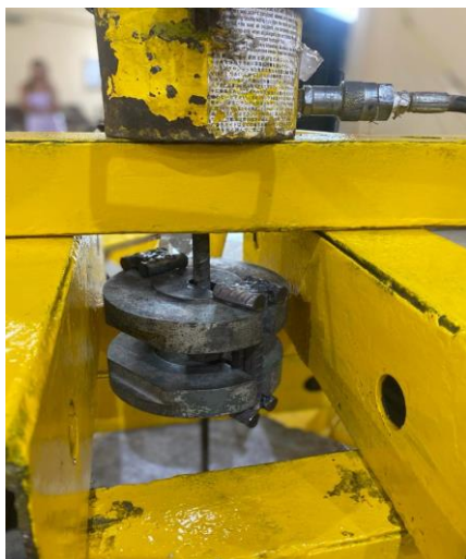
Figura 3.6 - a) Sistema de transferência de carga para o pino ensaiado; b) LVDT para medição do deslocamento do pino durante o ensaio
