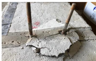
Figura 2.14 - Modos de ruptura, falha da ancoragem em função do efeito de grupo
